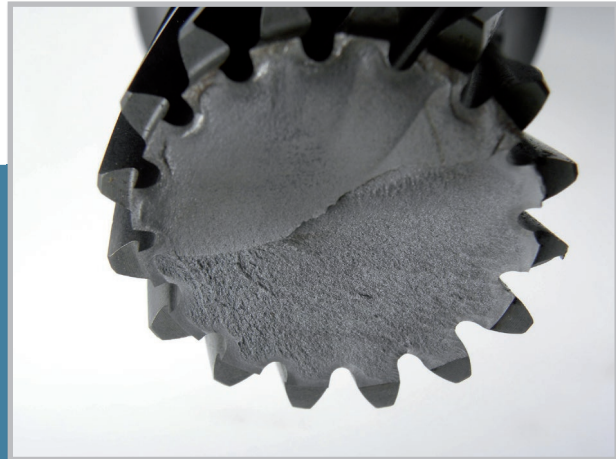
01 Riss- und Bruchuntersuchung der Pressverbindung mit Freistich und unterschrittener Fuge, \xi = 1,7\%
