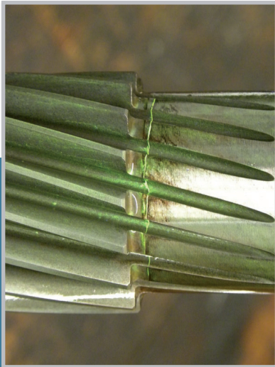
01 Riss- und Bruchuntersuchung der Pressverbindung mit Freistich und unterschrittener Fuge, \xi = 1,7\%
